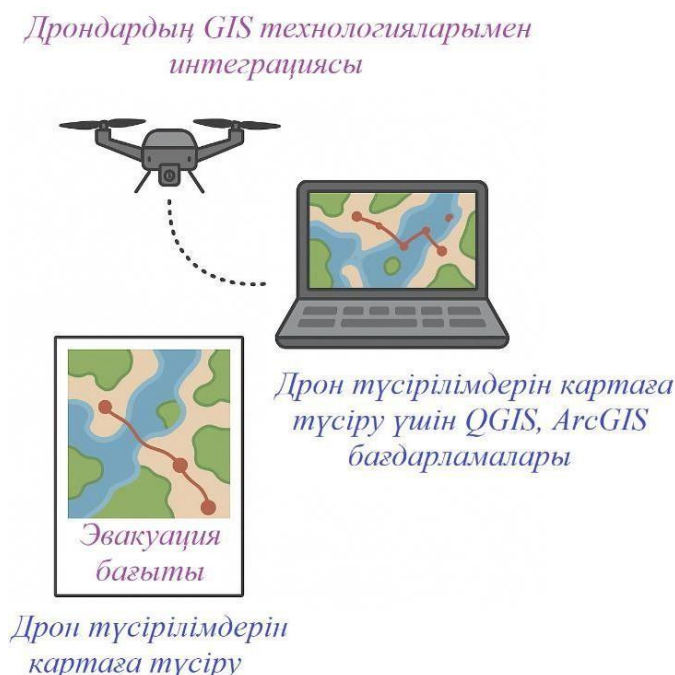
1.7-сурет – Дрондардың геоақпараттық жүйелермен (GIS) интеграциясы арқылы эвакуация бағыттарын жоспарлау үрдісі
